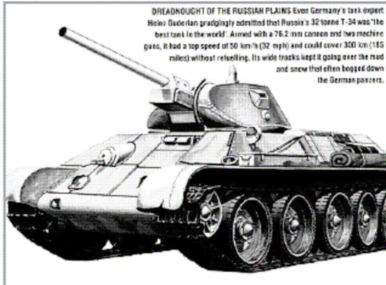
(Fig. "DREADNOUGHT DELLA CAMPAGNA DI RUSSIA, come anche ammesso con riluttanza dall'esperto di carri armati tedeschi, Heinz Guderian, il T-34 Russo di 32 tonnellate era "il migliore carro armato del Mondo,.." Munito con un cannone da 76.2 millimetri e con un'autonomia fino a 300 Km (185 miglia) senza necessità di rifornimento di carburante. I suoi cingoli larghi gli hanno permesso di superare il fango e la neve dove spesso si sono impantanati i Panzers tedeschi").
